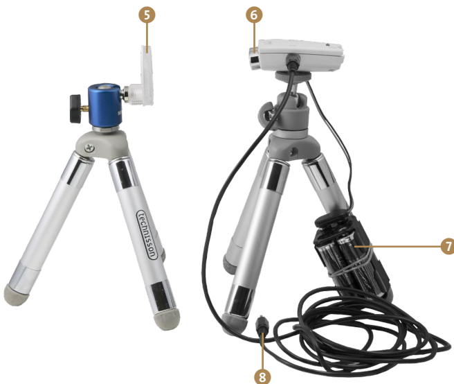
▲ Einfache Reflexlichtschranke »Jokie« von Eltima-Electronic mit einem Reflektor 5 , einem Sender-Empfänger-Gerät 6 , angeschlossener Stromversorgung 7 und einem Fernauslöserkabel zur Kamera 8
