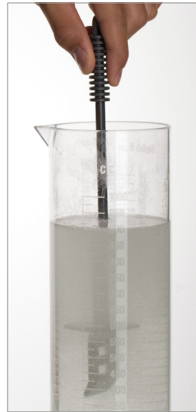
« Abbildung 5.7 Ansatz einer Entwickler- Stammlösung mit Kodak D-76. Das Pulver muss durch Rühren gut aufgelöst werden.
