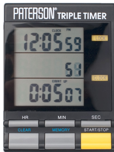
⤴ Abbildung 5.5 Mit dem Timer von Paterson können Sie drei Prozesszeiten voreinstellen.
