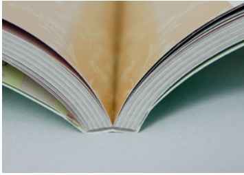
Abb. 4.4: Bei der Klebebindung verbindet ein stabiler Klebstoff die Seiten und es entsteht ein Falz in der Buchmitte.
