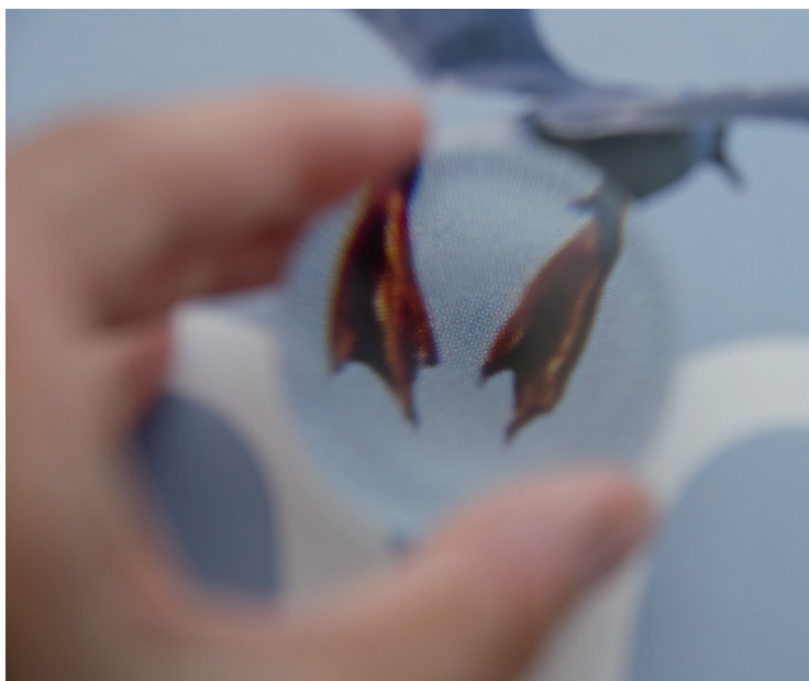
Abb. 2.4: Beim digitalen Offsetdruck ist bei der Betrachtung mit der Lupe ein Druckraster sichtbar – beim Ausbelichten auf Fotopapier nicht.
