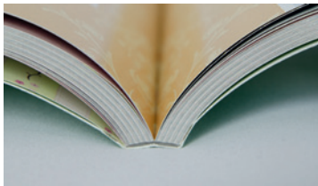
Abb. 2.9: Ein Qualitätsfaktor ist die Bindung. Diese ist unterschiedlich stabil. Moderne PUR-Klebebindungen wie in der Abbildung sind bei guter Verarbeitung so stabil wie eine klassische Fadenbindung.
