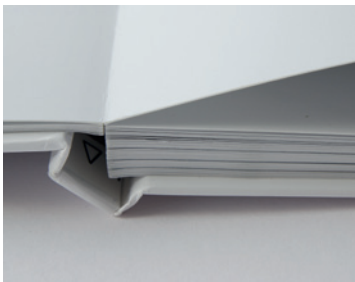
Abb. 4.6: Die »Lay-Flat«- oder Leporello-Bindung wird typischerweise für Echtfoto-Bücher eingesetzt. Sie bietet den Vorteil absoluter Planlage.
