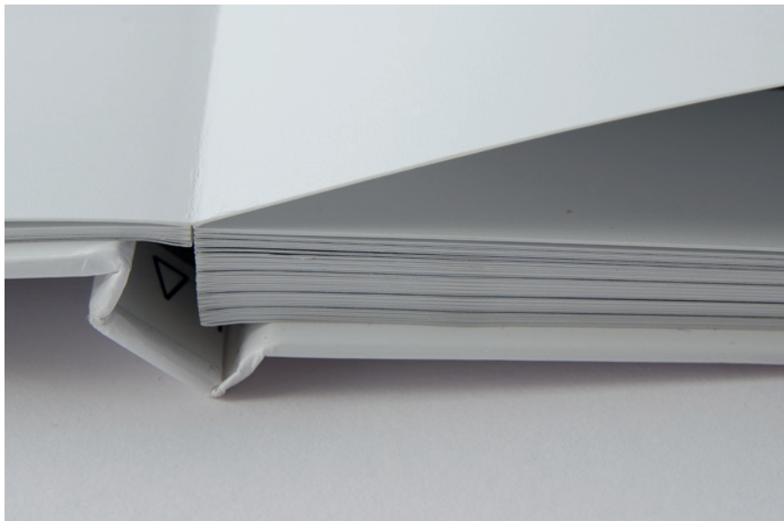
Abb. 2.6: Bei der Ausbelichtung auf Fotopapier sind die Seiten deutlich dicker, da zwei Papiere Rücken an Rücken verklebt werden.
