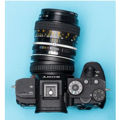
▲ Abbildung 3.38 Analoge Objektive lassen sich an spiegellosen Kameras mit Tilt-Adaptoren verwenden. Mit diesem Adapter lassen sich Nikon-Objektive bis zu 8° verschwenkt an einer Sony E-Mount-Kamera verwenden.
