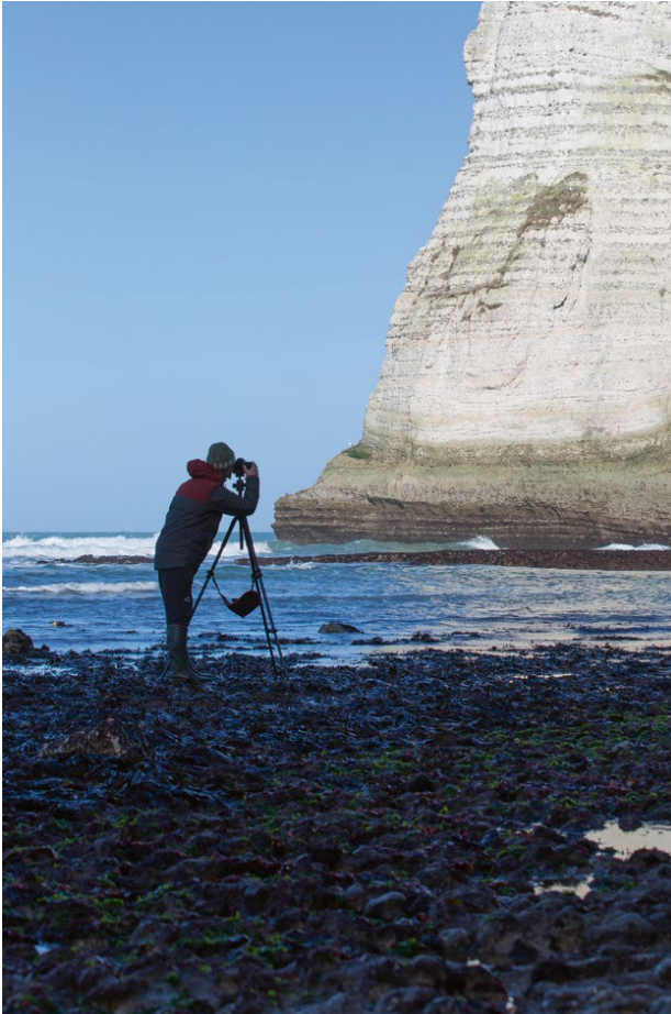
Ein hohes Stativ ermöglicht eine bequeme Körperhaltung bei der Ausschnittwahl. Zur Reduzierung von Schwingungen verzichtet man auf den Auszug der Mittelsäule. © Jacques Zanirato
