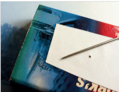
Abb. A-7 Das (hier etwas groß geratene) Nadelloch dient später als Objektiv. Als Material verwenden wir hier selbstklebende lichtdichte Folie, es geht aber genauso gut mit Alufolie und Klebeband.
