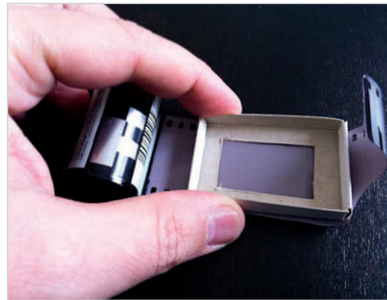
Abb. A-5 Die Breite der Streichholzschublade passt genau auf die Breite des Films. Durch das Loch in der Schublade wird der Film später belichtet.
