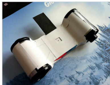
Abb. A-10 Ein selbst gebastelter Schieber aus schwarzer Pappe vervollständigt die Kamera.
