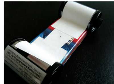
Abb. A-9 Mit lichtdichtem Klebeband wird die Lochkamera Stück für Stück abgeklebt. Das einzige Licht, welches der Film sehen darf, ist das durch die Lochblende eindringende Licht.
