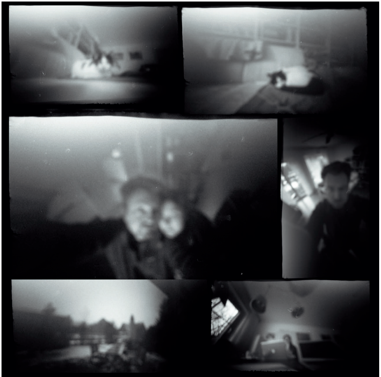
Abb. A-11 Resultate. Wegen des kleinen Filmformats und dem etwas zu groß geratenen Loch sind die Bilder recht unscharf. Durch den kurzen Abstand der Lochblende zum Film ist die Brennweite aber sehr weitwinklig geworden. Die Belichtungszeiten der Fotos betrug ca. 1–2 Sekunden im Zimmer. Auch durch diese höhere Belichtungszeit sind die Bilder nicht besonders scharf ausgefallen. Für weniger Unschärfen erstellen Sie ein kleineres Loch und fixieren Sie die Kamera, zum Beispiel auf einem Stativ. Sie müssen dann noch die Belichtungszeiten der kleineren Lochblende anpassen.
