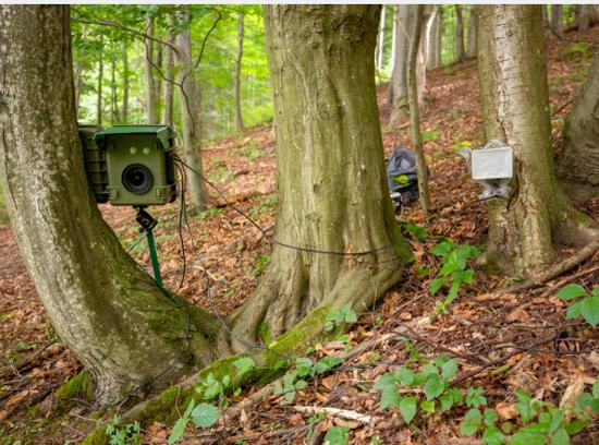
Die Kamerafalle ist mittels Schwerlastkonsole und Kugelkopf an einen Baum geschraubt. Der Eigenbau PIR-Auslöser ist fix in das Gehäuse eingesetzt.
