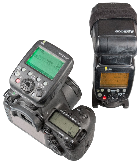
▲ Funkblitzauslöser Yongnuo YN-E3-RT an der Kamera (links) und Canon Speedlite 600EX-RT mit aktiviertem Funkempfang (rechts)
