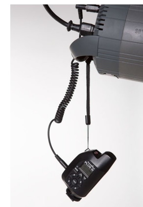
Funkempfänger am Blitzkopf
