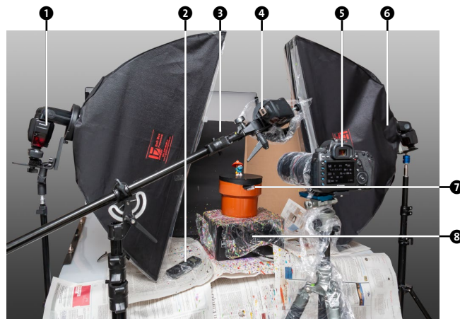
⤵ Making-of: Blitz mit Receiver und Strip-Softbox ①, Blitzfernauslöser ②, schwarzer Hintergrund auf Kartonwand ③, Galgenstativ mit Servo-Blitz ④, Kamera ⑤, Servo-Blitz mit Strip-Softbox ⑥, gespanntes Rohrstück ⑦, Subwoofer ⑧
