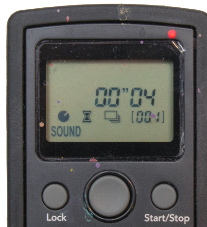
« Blitzfernauslöser im Modus SOUND mit einer Auslöseverzögerung von vier hundertstel Sekunden.
