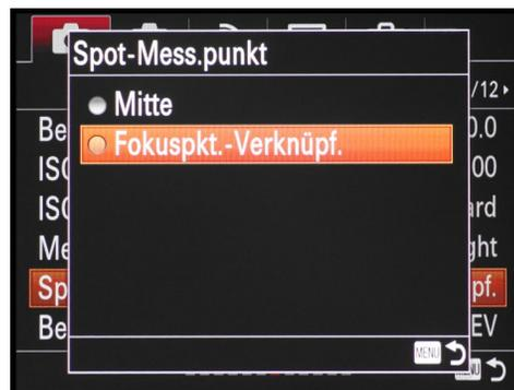
Menüpunkt zur Verknüpfung des Spotmesskreises mit dem aktiven AF-Feld bei einer Sony-Kamera
