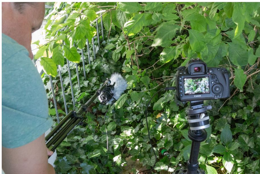
↑ Externes Mikrofon, über ein Verlängerungskabel mit der Kamera verbunden
