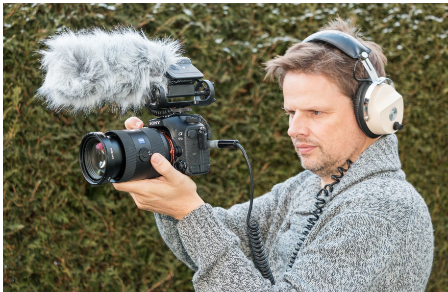
↑ Das sehr leichte Richtmikrofon VideoMic von Røde kann am Blitzschuh befestigt und an der Mikrofoneingangsbuchse der Kamera angeschlossen werden.
