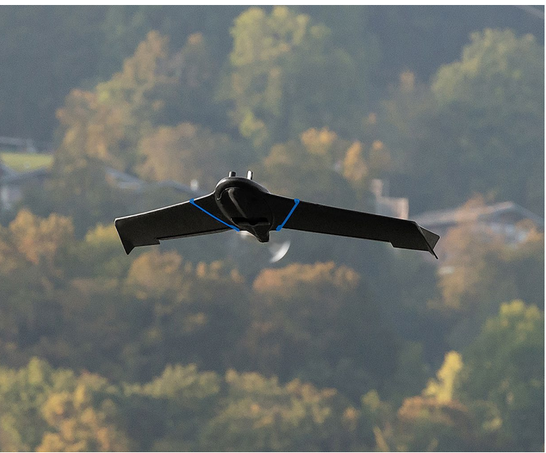
⚡ Abbildung 1.9 Wegen ihrer hohen Reichweite und hervorragenden Gleiteigenschaften werden Starrflügler gern bei industriellen Einsätzen genutzt. Herkömmliche Starrflügler sind in der Luft kontinuierlich in Bewegung und somit zum gezielten Aufnehmen einzelner Motive ungeeignet. (Foto: AgEagle)
